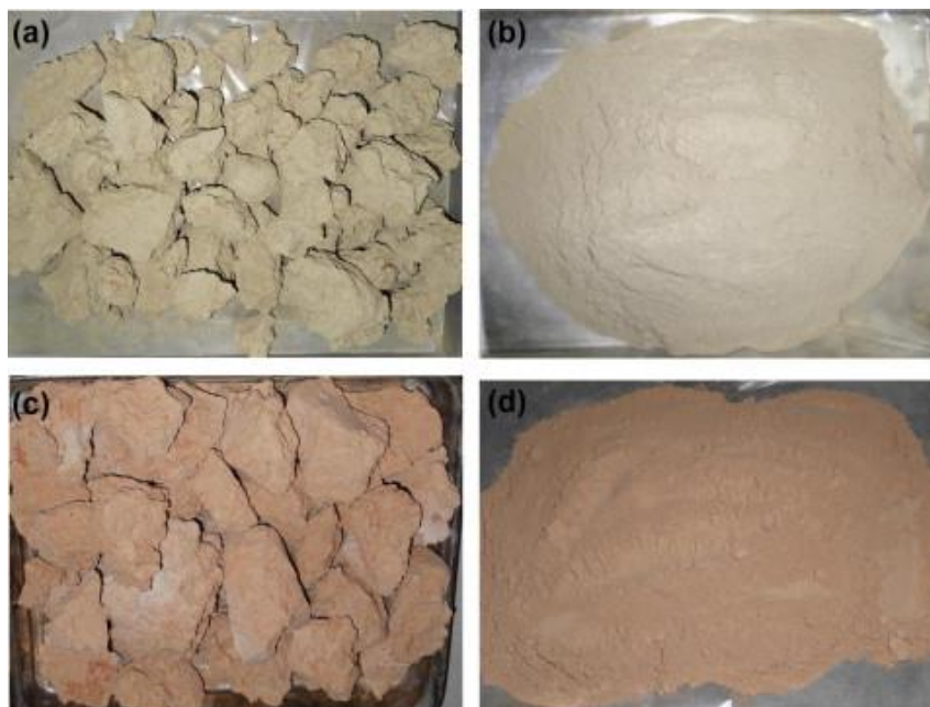
Figura 2.9 – Aspecto Físico do LETA: a) LETA seco em forno a 110 °C; b) LETA moído; (c) CLETA ativado termicamente a 800 °C e (d) CLETA ativada termicamente moída. (HAIDER et al. , 2014)
