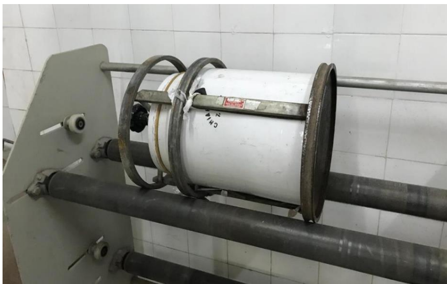
Figura 3.7– Processo de moagem do resíduo.
